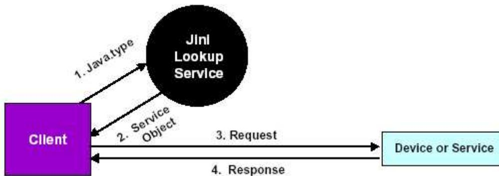
Sucht eine Jini-Einheit nach einem bestimmten Service, so muss diese eine Anfrage an einen LUS stellen. Der LUS kann nach konkreten Services, Typen von Objekten (wie in der Abb. dargestellt), Superklassen, übergeordneten Schnittstellen und Attributen der vom LUS erfassten Dienstelemente durchsucht werden. Nach einer Suche erhält der Client vom LUS ein Service-Objekt, mit welchem er dann direkt (per Unicast) mit dem gewünschten Service kommunizieren kann.
